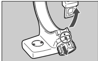
**1** Поверните винт замка против часовой стрелки, чтобы его ослабить (около 3 оборотов), затем потяните винт в направлении, указанном стрелкой, чтобы расцепить воротник штативной пятки.
