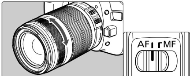
Для съемки в режиме автоматической фокусировки установите переключатель режимов фокусировки в положение AF. Чтобы использовать только ручную фокусировку, установите переключатель режимов фокусировки в положение MF и настройте фокусировку, поворачивая фокусировочное кольцо.
