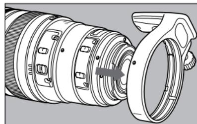
**3** Снимите воротник штативной пятки, сдвинув его в направлении задней части объектива.
