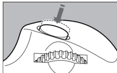
**3** При нажатии кнопки спуска наполовину стабилизатор изображения начинает работу.
